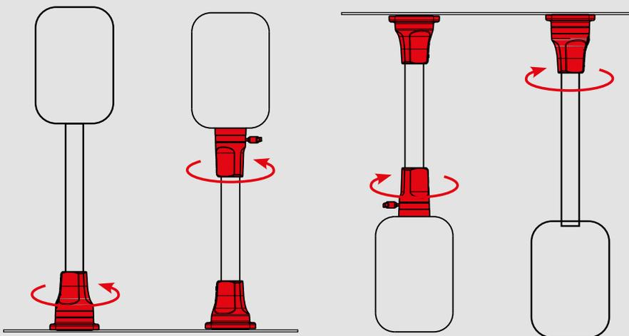
**Maschinenanbindung mit drehbarem Winkel**
