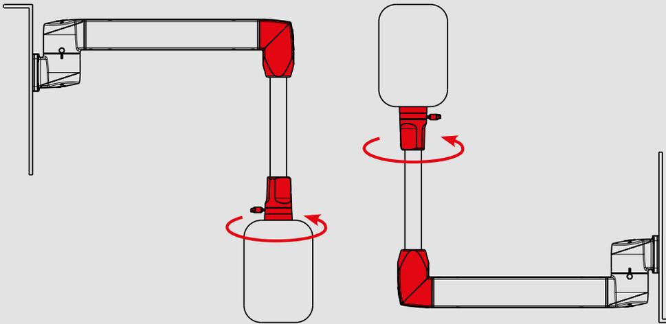
**Anbindung von unten/oben mit Kupplung und Standfuß**
