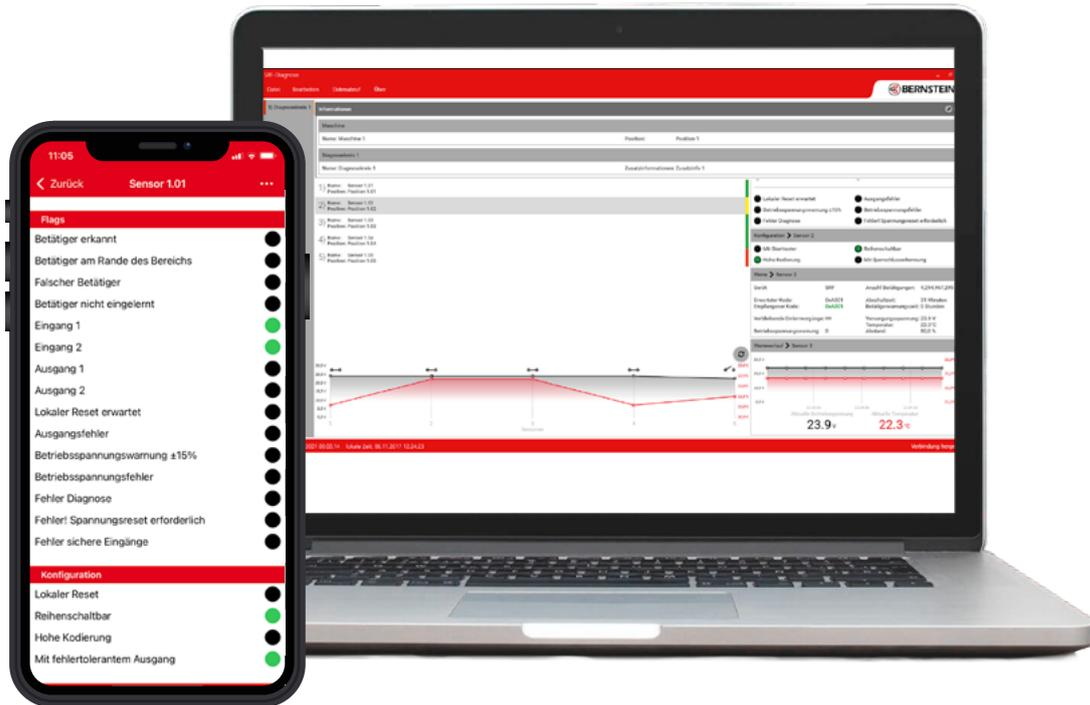
Um die Zuordnung der Informationen zu vereinfachen, ist es möglich, jedem Sensor, jeder Sicherheitskette und der Maschine einen Namen und einen beschreibenden Text dauerhaft zuzuordnen, sodass der Anwender den entsprechenden Sensor einfach identifizieren kann.
