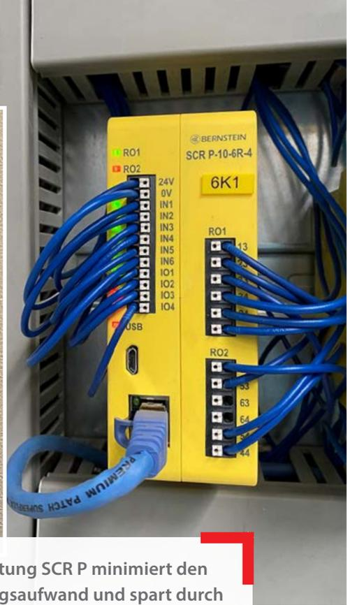
Die Auswertung SCR P minimiert den Verdrahtungsaufwand und spart durch die Kombination mehrerer Sicherheitsrelais in einem Gerät deutlich Platz im Schaltschrank.
