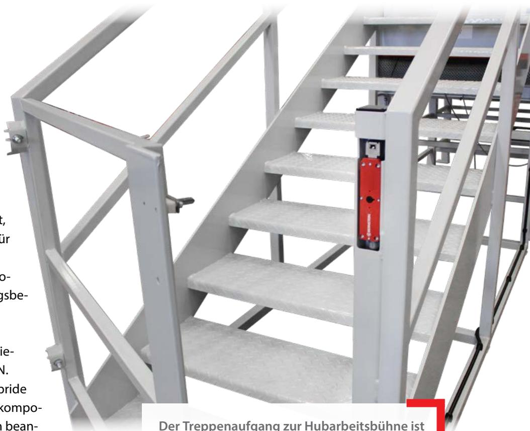
Der Treppenaufgang zur Hubarbeitsbühne ist mit der Sicherheitszuhaltung SLC gesichert. Sobald die Bühne in Bewegung ist, hält der SLC den Zugang geschlossen.
