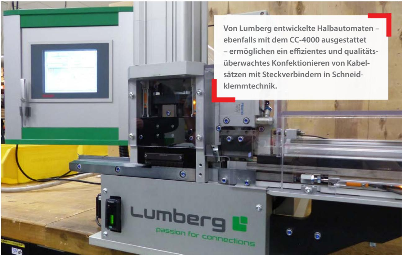
Von Lumberg entwickelte Halbautomaten – ebenfalls mit dem CC-4000 ausgestattet – ermöglichen ein effizientes und qualitätsüberwachtes Konfektionieren von Kabelsätzen mit Steckverbindern in Schneidklemmtechnik.
