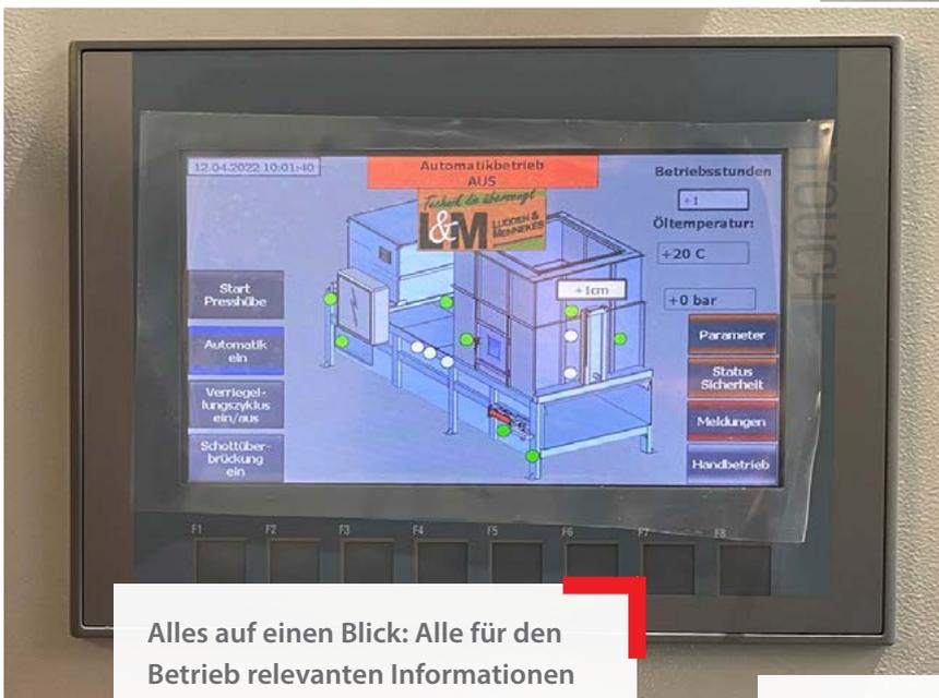
Alles auf einen Blick: Alle für den Betrieb relevanten Informationen über die Anlage erhält der Bediener übersichtlich auf einem Display. Hier ist auch schnell erkennbar, welcher Sicherheitsensor SRF eine Störung meldet.
