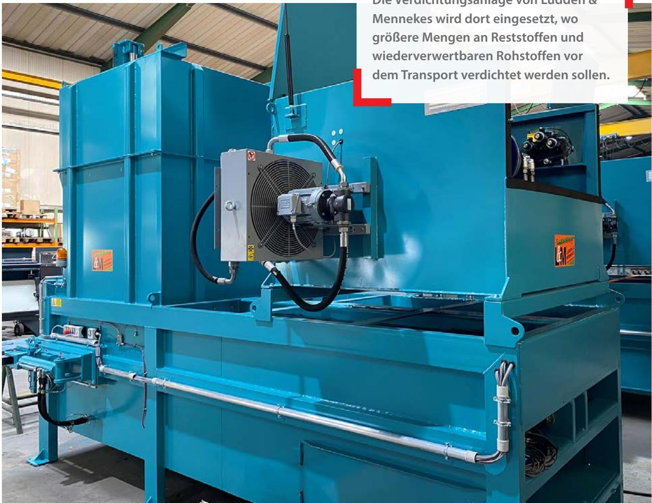
Die Verdichtungsanlage von Ludden & Mennekes wird dort eingesetzt, wo größere Mengen an Reststoffen und wiederverwertbaren Rohstoffen vor dem Transport verdichtet werden sollen.
