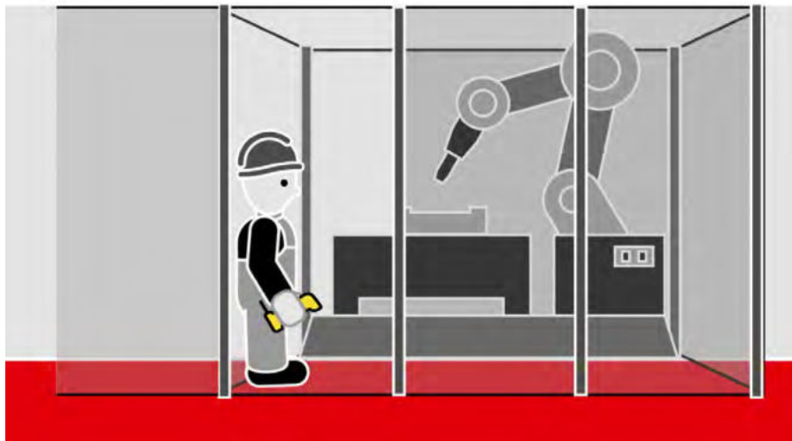
Teachen einer Roboterfunktion durch einen handbetätigten Zustimmungsschalter
