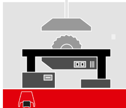
Fußschalter mit Sicherheitsrastung und Handentriegelung an einer Holzbearbeitungsmaschine
